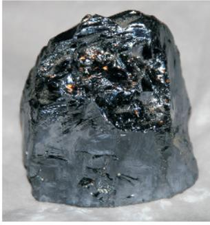
图1 硅. 因为容易实现 p-型和 n-型掺杂(doping), 所以这种其貌不扬的物质奠定了信息革命的基础; 又因为它容易掺杂(polluted by impurities) 所以高纯硅的价格才一直居高不下
