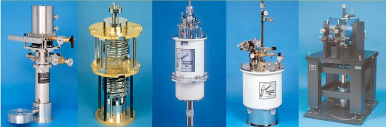
**10 mK to 800 K      LHe/LN<sub>2</sub> Cryostats**
